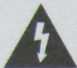
Молния со стрелкой внутри равностороннего треугольника предназначена для предупреждения пользователя о присутствии под кожухом продукта неизолированного «опасного напряжения», которое может быть достаточно для того, чтобы представлять риск поражения электрическим током.
